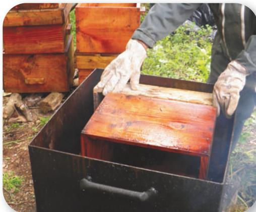
**Une installation en plein air pour le traitement à la cire microcristalline : la cuve est partiellement remplie, les faces sont trempées l'une après l'autre.**
